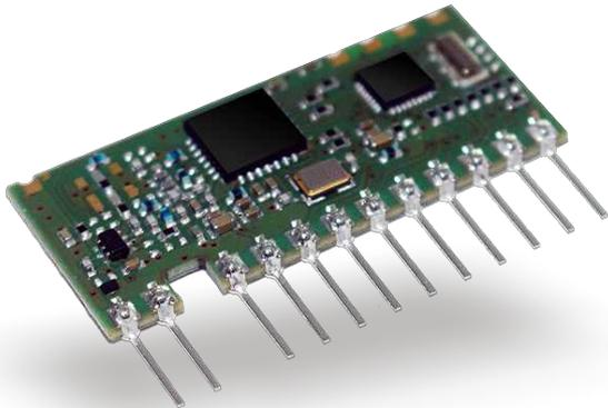
XTR-8LR10 è un ricetrasmittitore half-duplex per comunicazioni a lunga distanza che implementa una tecnica di modulazione brevettata “LoRa SSM”, in grado di garantire caratteristiche di elevata immunità alle interferenze, con ridotti consumi energetici con potenza di +14 dBm ed elevata sensibilità.
